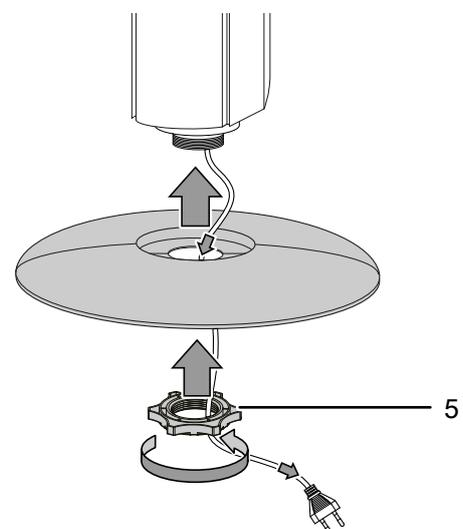
4. Portare il cavo elettrico al di sotto del piedino d'appoggio, attraverso le linguette, come mostrato nella figura, per garantire una stabilità sicura del ventilatore.
