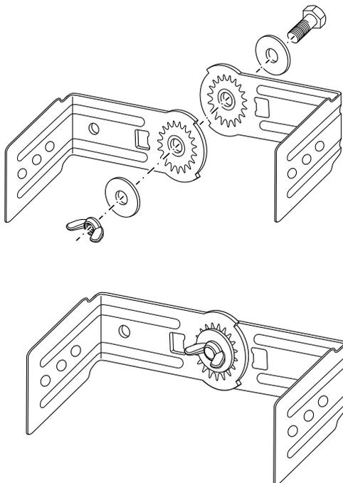
2. Atornille la escuadra de fijación usando los tornillos de fijación al soporte para el montaje en pared o techo. Los soportes pueden desplazarse a voluntad. Se recomienda una distancia de 45 a 55 cm entre sí.
